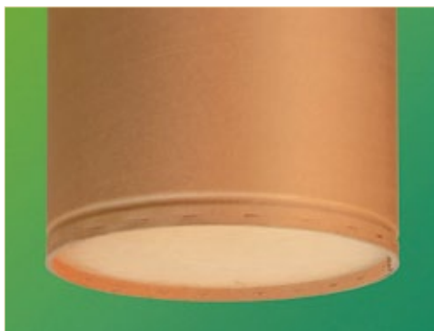
MDF-Boden formschlüssig zwischen Sicke und Stoß-Pappring geklemmt und geheftet
